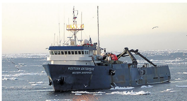
КС «Вестерн Энтерпрайс», на котором автор впервые вышел в море для сбора информации при промысле крабов (год постройки: 1980, США, Мосс-Пойнт; экипаж 27 человек; оснащён прямоугольными ловушками «американской» конструкции и рассольным типом заморозки продукции)
