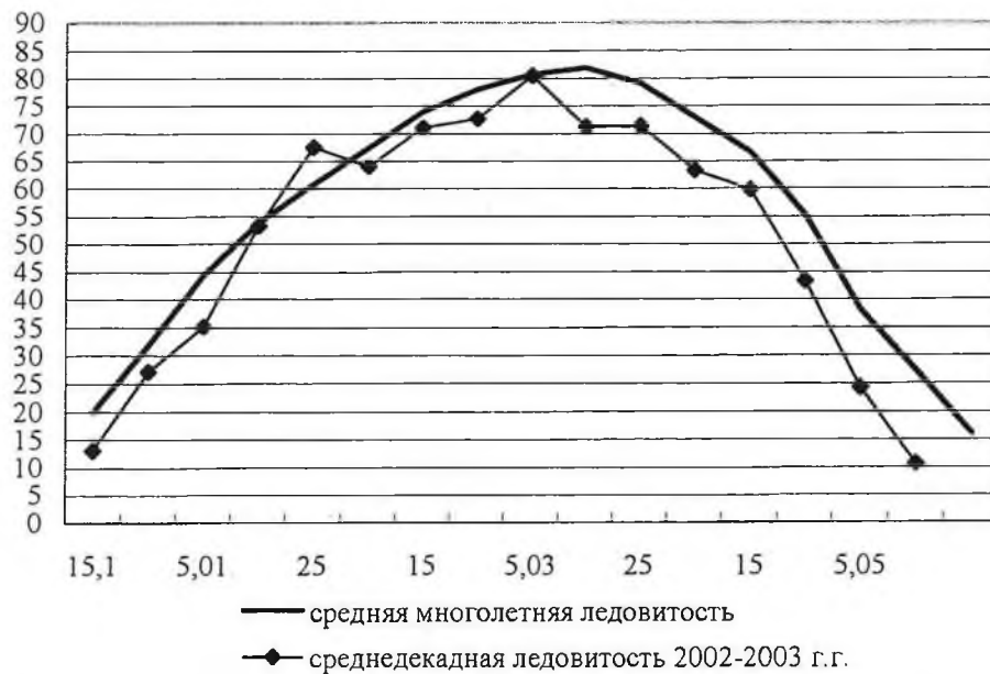
Рис. 1. Динамика развития и разрушения расчетной (А) и среднедекадной (Б) площади ледовых полей в Охотском море в 2002–2003 гг., %
