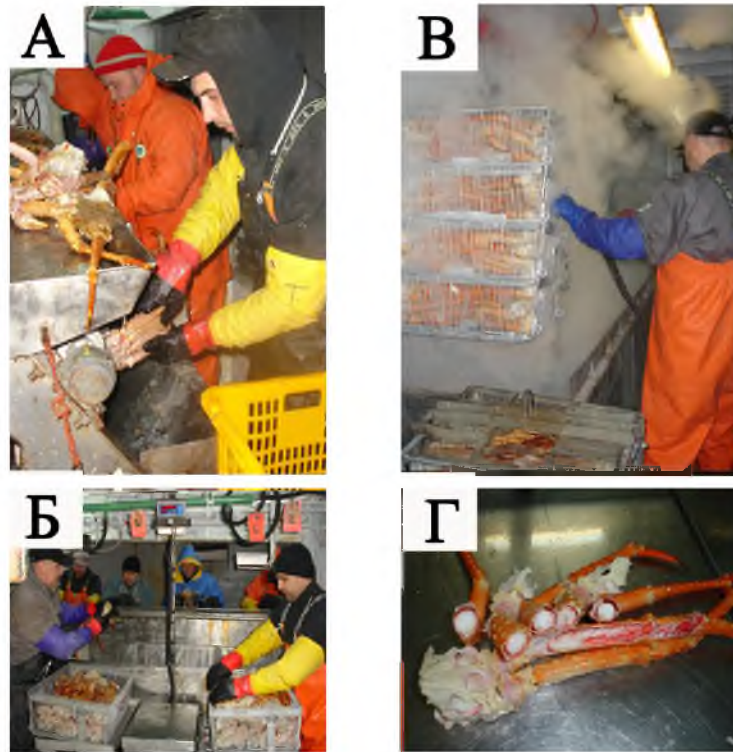
Рис. 6.25. Процесс обработки краба в цеху краболовного судна «Шантар-1»: А – разделка и обработка, Б – укладка секций краба, В – варка, Г – анализ качества продукции
