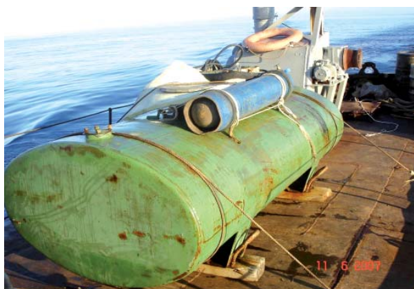
Рис. 78. Общий вид живорыбной емкости с кислородной продувкой
