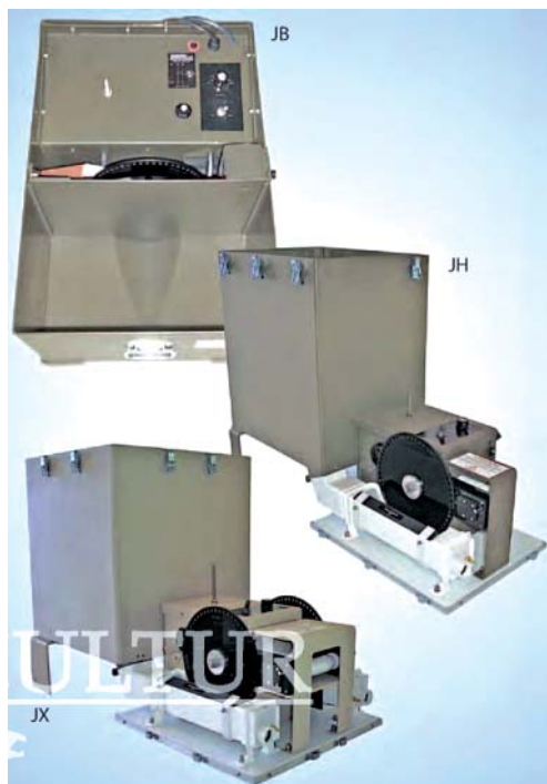
Рис. 40. Модификации машин J-SORTER для сортировки икры
