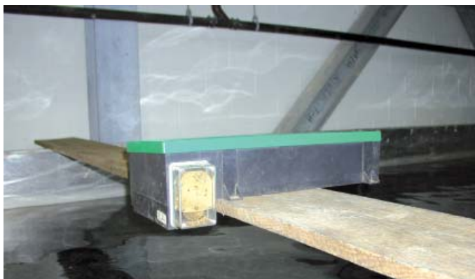
Рис. 74. Автоматический кормораздатчик с часовым механизмом
